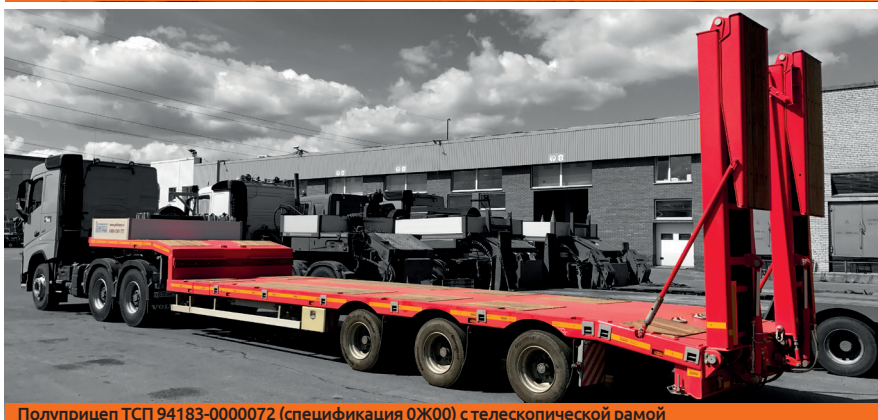
Полуприцеп ТСП 94183-0000072 (спецификация 0Ж00) с телескопической рамой
